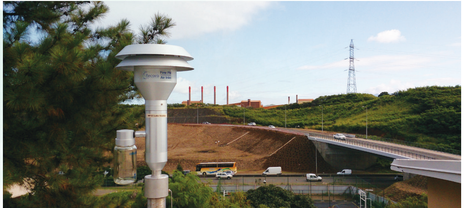
Tête de prélèvement de poussières à l'école Griscelli et cheminées de la centrale thermique en arrière plan.
