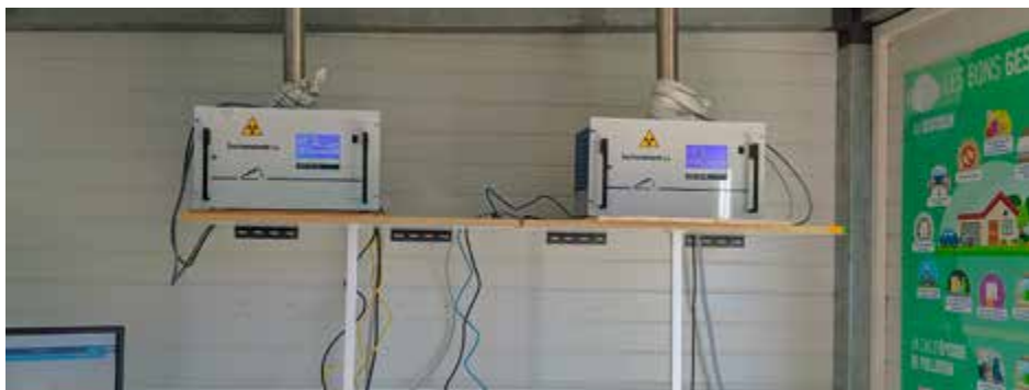
Deux MP101, pour la mesure des PM10 et des PM2.5, à la station de l'Anse Vata.
