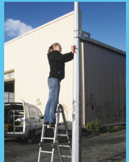
Pose d'un échantillonneur sur un lampadaire
