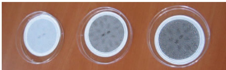
Particules fines prélevées sur filtre avant le dosage des métaux en laboratoire
