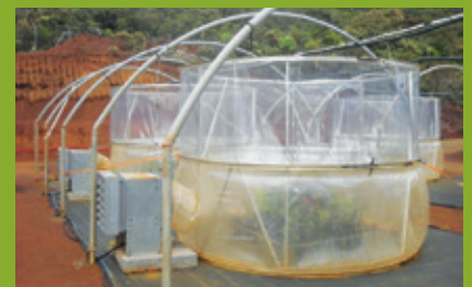
Installation de VALE NC pour les tests de fumigation consistant à exposer une dizaine d'espèces endémiques à différentes gammes de concentrations en dioxyde de soufre
